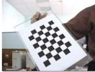
**Figura 2-3 Esempio di scacchiera per la calibrazione**
