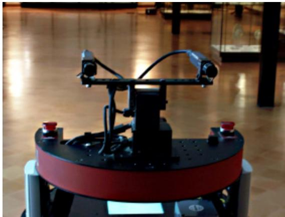
**Figura 4-3 Unità Pan-Tilt del robot B21r**
