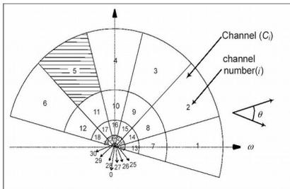
La frequenza  $\omega$ , normalizzata tra 0 ed 1, è data da  $\omega = \Omega / \Omega_{\max}$ . Essendo  $\Omega_{\max}$  il massimo valore di frequenza dell'immagine.
