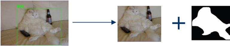
Un insieme di caratteristiche di natura intrinseca dell'oggetto quali il colore, la forma, la tessitura vengono calcolate in maniera automatica e permettono di associare al video object la sua descrizione in metadati e senza la quale non sarebbe possibile l'effettivo riutilizzo di un video oggetto; tale descrizione potrà ulteriormente essere arricchita tramite annotazioni con informazioni non ricavabili automaticamente ma ugualmente caratteristiche del VO.
