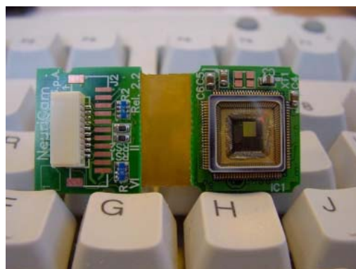
Figura 2.2: Struttura del chip: memorie, connettori e tutti i componenti passivi collegati ad essi.
