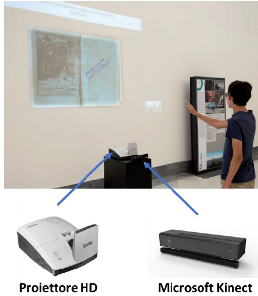
Figura 3 – Prototipo “Proiezione interattiva di testi antichi”
