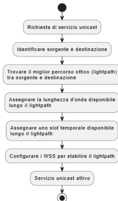
Figura 2: Diagramma di flusso che illustra le fasi del processo RWTa (Routing, Wavelength, Time Slot Assignment) per l'instaurazione di servizi unicast in una rete Spine-Leaf All-Optical (AOSL).
